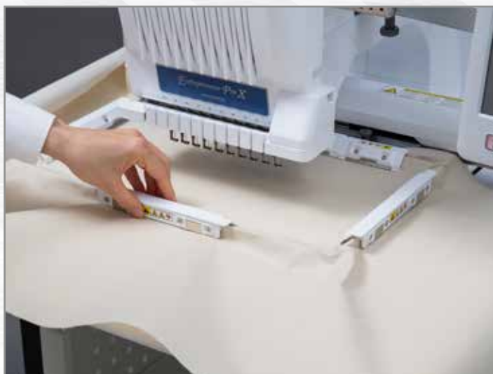
Eenvoudig inspannen, plaats alleen de magneet delen
