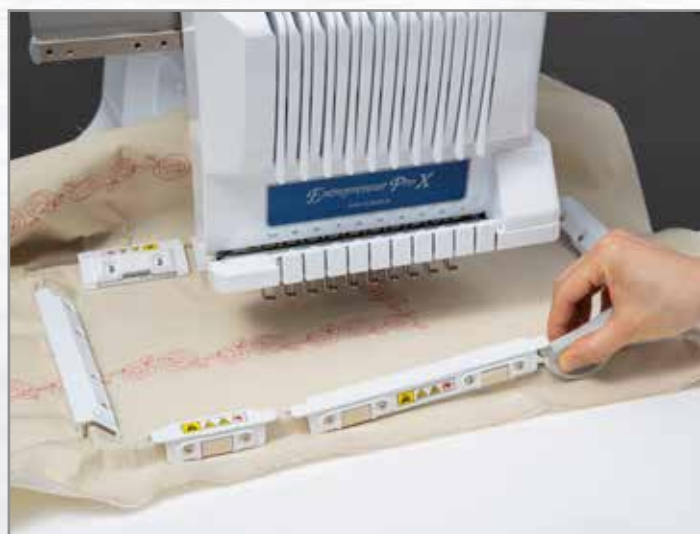
Inclusief magneet lifters, eenvoudig om de magneten te verplaatsen
